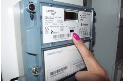
Hitta lysdioden på elmätaren som är märkt 1000 IMP/kWh
